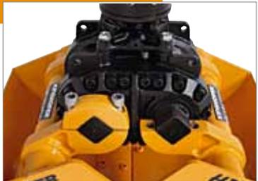
Die Schalen des **HPXdrive** sind sehr einfach durch das Lösen der Halteschrauben wechselbar. Somit kann mit einer Antriebseinheit auf verschiedene Anwendungen umgerüstet werden wie z.B. auf Universal-, Stein-, Holzgreifer oder Heu- und Forstgreifer.
